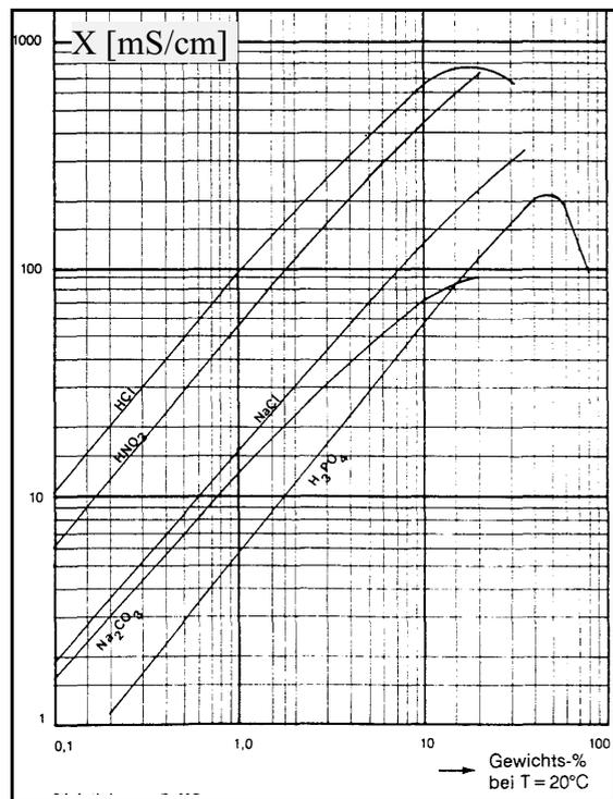
Abb. 3: LF-Werte einiger gebräuchlicher Elektrolyte bei verschiedenen Konzentrationen
