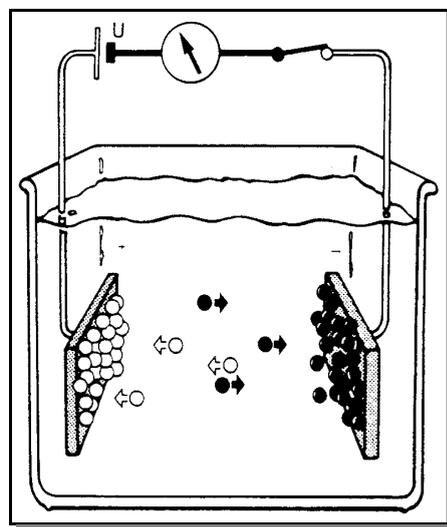
Abb. 6: Angelegte Spannung => Ionenwanderung und Entladung
