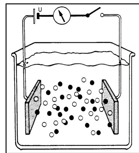
Abb. 5: Keine Spannung => freie Ionenbeweglichkeit
