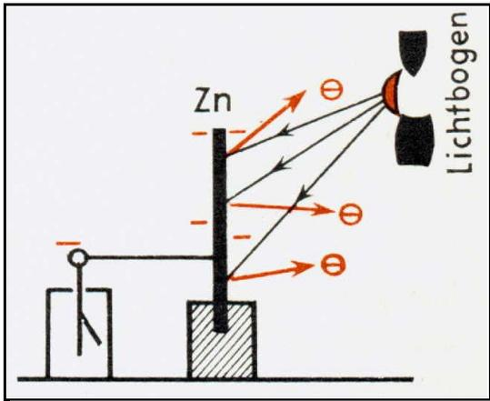
Abb.4-1: Lichtelektrischer Effekt
