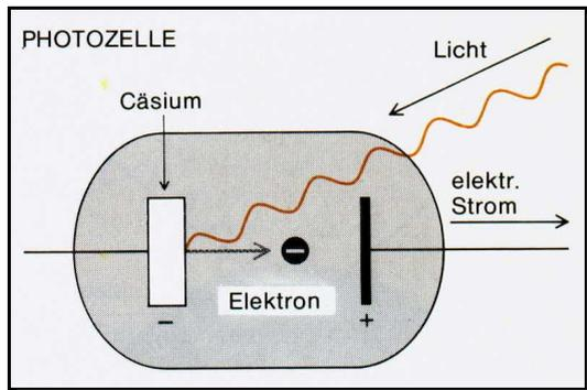
Abb.4-2.: Trifft Licht auf metallisches Caesium, werden Elektronen aus der Metall-Oberfläche herausgeschlagen.
